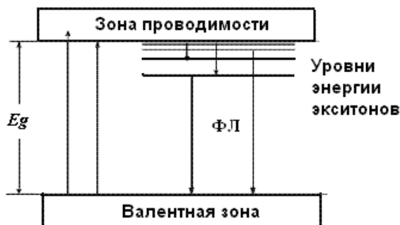
Рис. 5. Схематическая диаграмма полосы экситонной фотолюминесценции наночастиц ZnO
