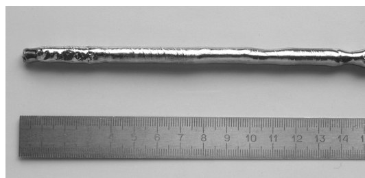
Рис. 3. Вид гафния после зонной плавки
