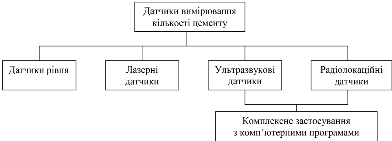
Рис. 3. Датчики вимірювання кількості цементу на складі (* Розроблено автором [6, 3.2])
