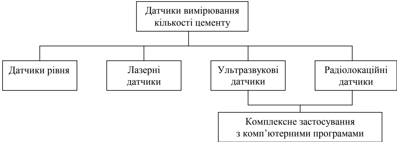
Рис. 3. Датчики вимірювання кількості цементу на складі (* Розроблено автором [6, 3.2])
