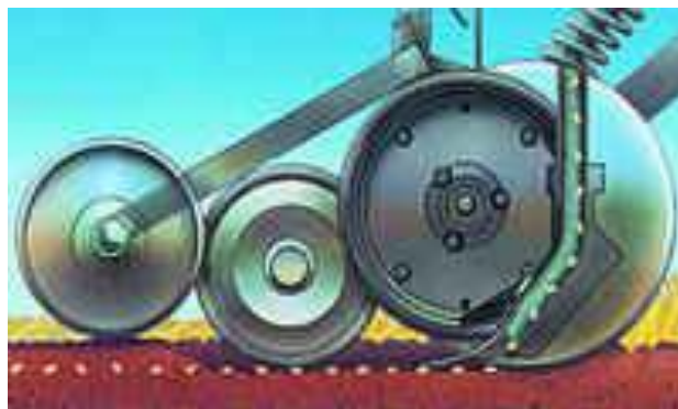
Рис.4 – Устрій сошникового блоку у сівалці для No-till John Deere 1890
