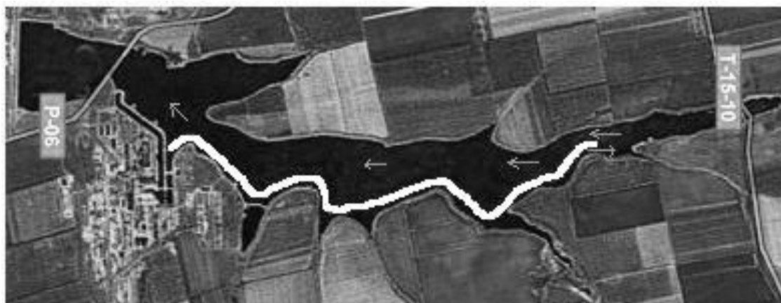
Рис. 1 – Схема возможного расположения в Ташлыкском водохранилище гидроизолированного водовода (белой линией показано положение его внешней стенки)
