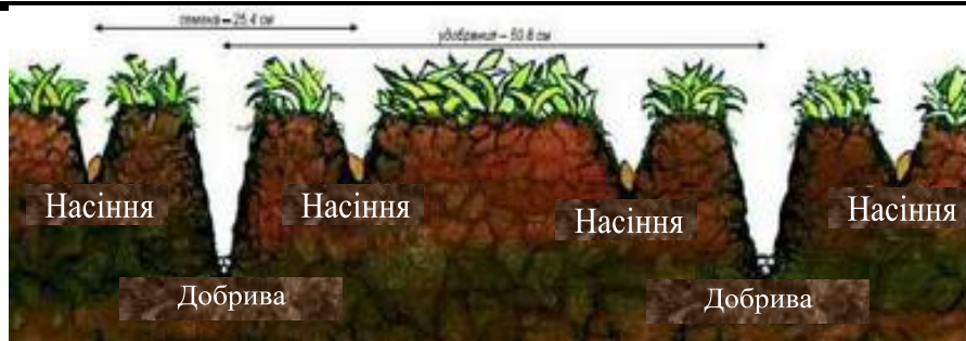
Рис.5 – Схема одночасної сівби і внесення мінеральних добрив сівалкою John Deere серії 1895
