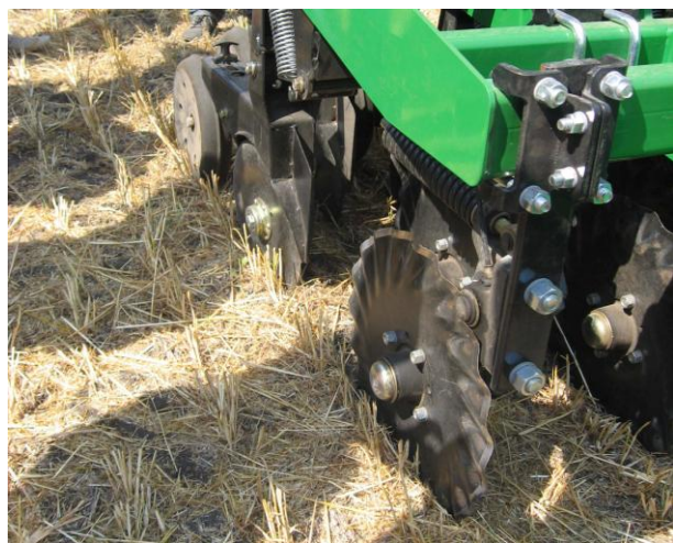
Рис.2 – Дискові ножі у сівалці для No-till, які виконують роль сохи, прорізаючи тонку борозну для насіння і не порушуючи ґрунт
