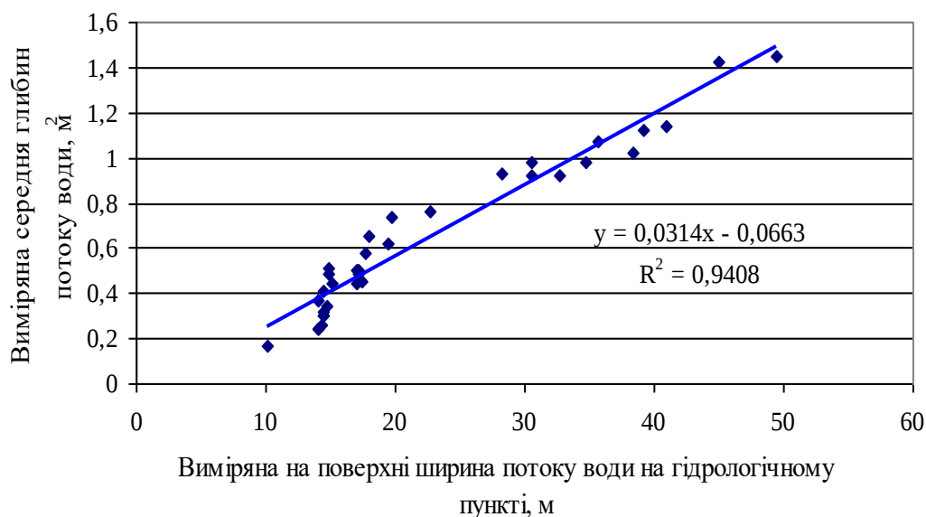
Рис. 3 – Залежність між шириною потоку води річки Роставиця та середньою глибиною води у пункті спостережень с. Матюши
