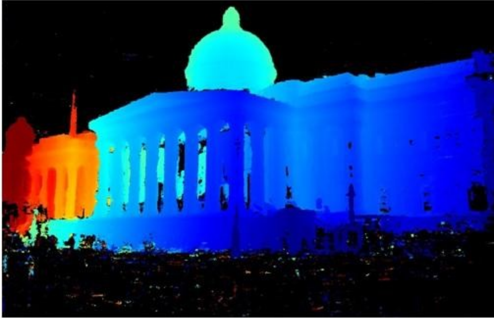
Рис. 4.1. Мапа глибини за допомогою COLMAP
