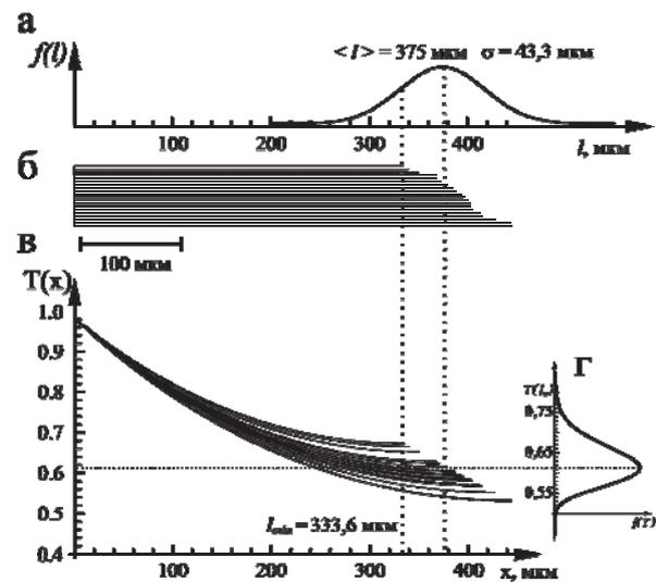
Рис. 3. а – плотность нормального распределения длин ветвей; б – дендрограмма модели; в – изображение пассивной электрической структуры модели при  $R_m = 5 \text{ кОм}\cdot\text{см}^2$ ; г – плотность распределения значений функции  $T(x)$  на маршрутном расстоянии  $x = 333,6 \text{ мкм}$ .
