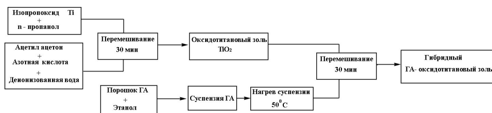
Рис.1 Схема процесса получения гибридного ГА-оксидтитанового золя для нанесения гибридных ГА- оксидтитановых покрытий методом погружения.
